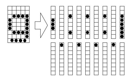
ESC & m c1 c2 x d1 d2 d3 d4 d5 d6 d7 d8 d9 d10 d11 d12 d13 d14 d15 d16 d17 d18 Code (Hex.) 1B 26 02 21 21 1C 00 00 80 22 00 00 80 22 00 00 80 3F 00
